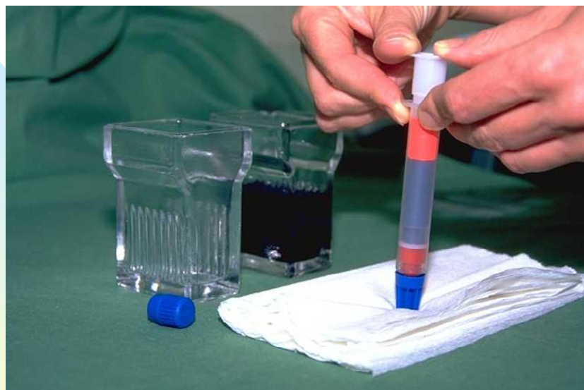
CellPrint-Instrument auf Unterlage aufsetzen und Filtrationstubus zur Instrumentenspitze drücken. Dabei wird die Flüssigkeit durch das Kapillarfilter gedrückt. Die Zellen werden an der Filterfront gesammelt.
